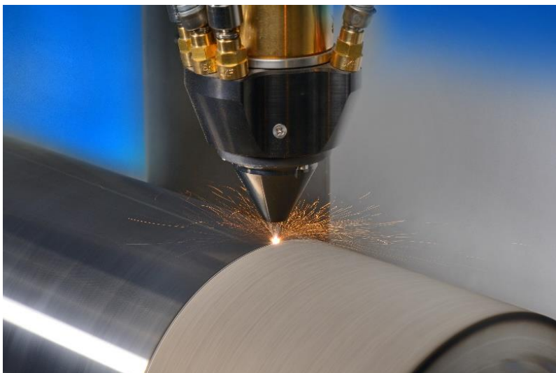
EHLA mit HighNo 4.0 – Pulverzufuhrdüse auf einer Welle
