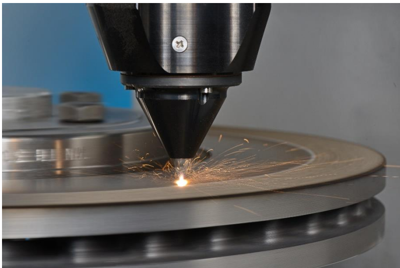
EHLA mit HighNo 4.0 – Pulverdüse auf einer Bremsscheibe
